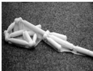
No entanto os robôs, durante todo o processo de evolução, apenas existiam virtualmente no programa do computador, não tendo sido construídos. A construção dos robôs seleccionados no fim do processo de evolução foi realizada também sem intervenção humana. O computador construiu automaticamente os robôs
